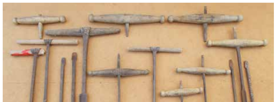
Bohrer aus einer Stellmacherwerkstatt (19.Jhd.), Spende von Marco Schreiber, Roitzsch bei Torgau
